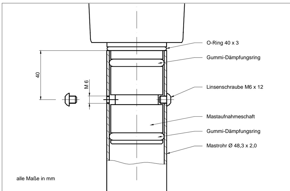
Bei dieser Anordnung wird die beiliegende Reduzierhülse nicht benötigt. Zur einfacheren Montage sollten Sie zunächst die beiden Gummi-Dämpfungsringe des Mastaufnahmeschaftes sowie die Innenseite des Mastrohres mit Vaseline oder Fett einschmieren. Setzen Sie nun den Windgenerator vorsichtig in das Rohr ein und schieben ihn weiter, bis der O-Ring 40x3 auf dem Rand des Rohres aufliegt. Achten Sie unbedingt darauf, die Dämpfungsringe beim Einfädeln nicht zu beschädigen.
