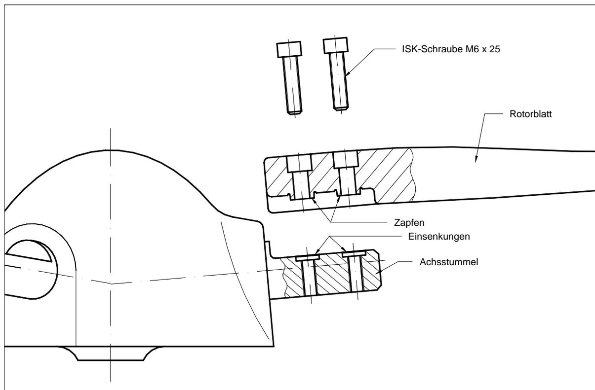
Zur Befestigung der Rotorblätter dienen je zwei Innensechskant-Schrauben M6 x 25, welche mit einer „TUFLOK“-Beschichtung als Sicherung gegen Lösen der Schraubverbindung im Betrieb versehen sind. Beim Eindrehen dieser Schrauben ins Gewinde ist aufgrund der Beschichtung ein gewisser Widerstand spürbar.
