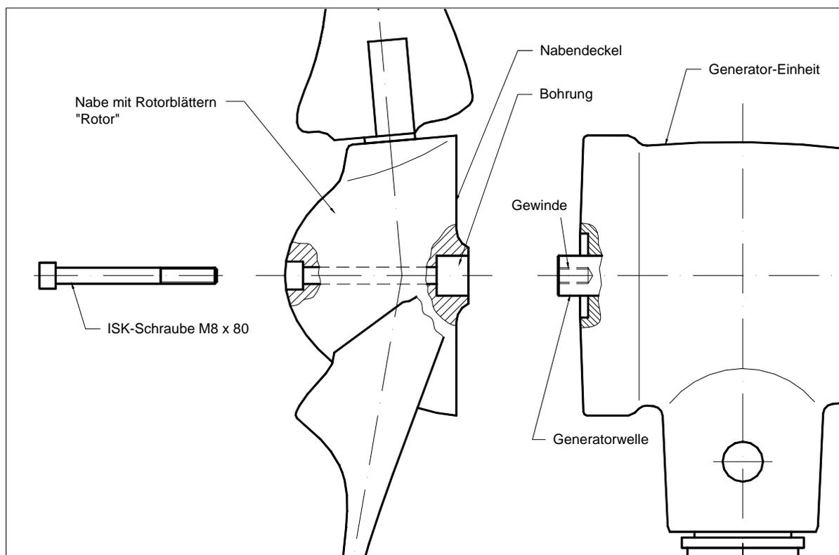
**WARNUNG:** Solange die Nabe noch nicht auf der Generatorwelle befestigt ist, können durch gewaltsames Hineindrücken der Welle Beschädigungen im Inneren des Generators verursacht werden. (Verlust der Garantie!)
