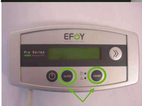
Bestätigen Sie nun den Filterwechsel über die Fernbedienung indem Sie die Tasten „Auto“ und „Reset“ gleichzeitig drücken. Die Service Meldung erlischt dann.
